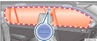
Рисунок 32 Левая сторона автомобиля: место установки и объем головной подушки безопасности
