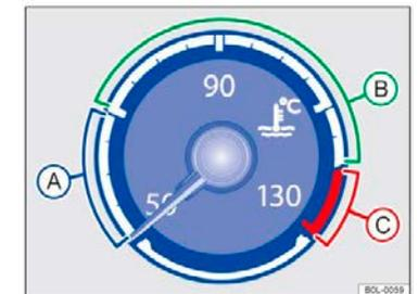
Рисунок 14 Указатель температуры охлаждающей жидкости двигателя на приборной панели
