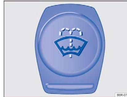
Рисунок 128 В моторном отсеке: крышка бачка стеклоомывателя
