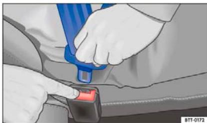
Рисунок 25. Высвобождение язычка из замка ремня безопасности.
