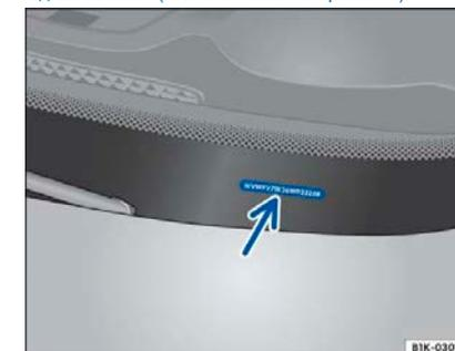
Рисунок 154 На лобовом стекле: Идентификационный код автомобиля
