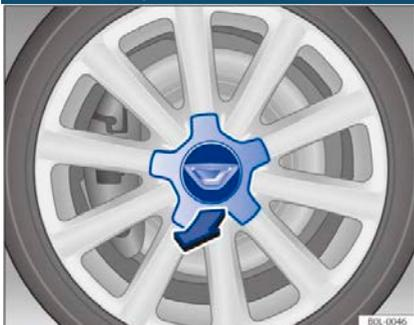
Рисунок 143. Снятие центральной накладки колеса
