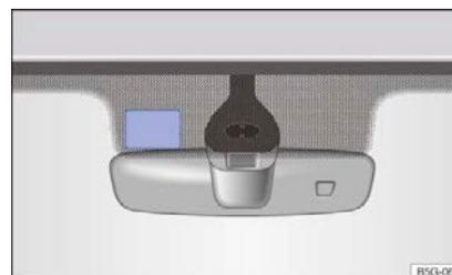
**Рис. 151 Коммуникационная зона (синяя область) на лобовом стекле (схематическое изображение)**
