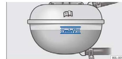
Рисунок 131 В моторном отсеке: Маркировка расширительного бачка охлаждающей жидкости двигателя (схематическое изображение)
