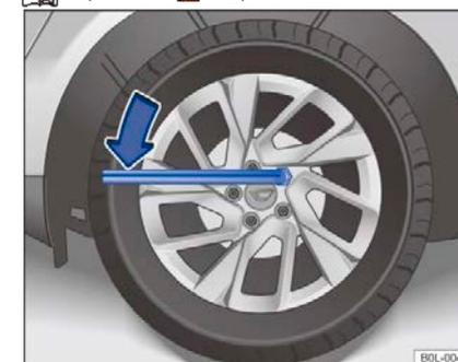
Рисунок 145. Замена колеса: ослабление колесных болтов
