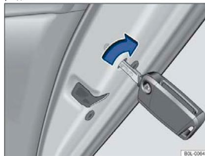
Рисунок 46 Торцевая часть правой двери: запирание автомобиля механическим ключом
