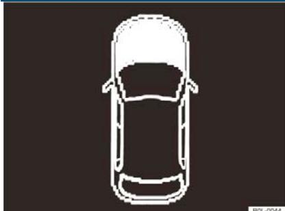
Рисунок 127 Экран приборной панели: крышка моторного отсека открыта или закрыта неплотно. Символ на экране приборной панели → Рис. 127 указывает на то, что крышка моторного отсека закрыта неплотно.
