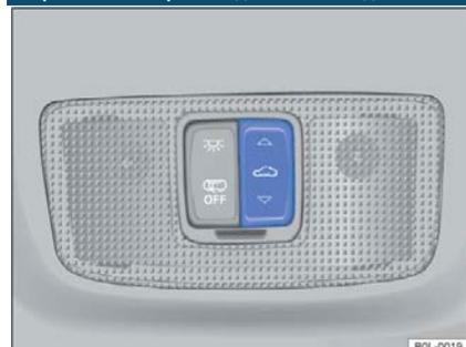
Рисунок 51 Потолок: кнопки сдвижного/откидного люка
