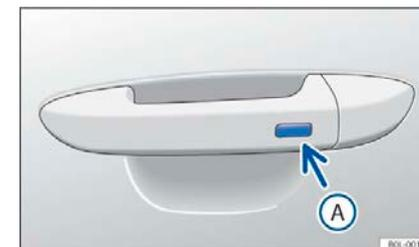
Рисунок 42 Дверная ручка: кнопка бесключевого доступа
