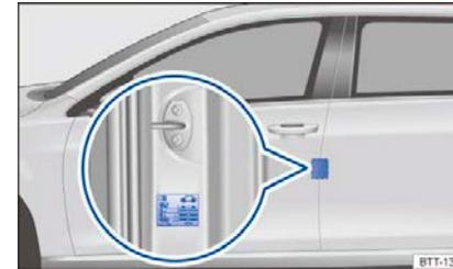
Рисунок 139 На стойке двери со стороны водителя: табличка давления в шинах
