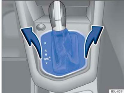
Рисунок 86 Снятие крышки гнезда переключения передач
