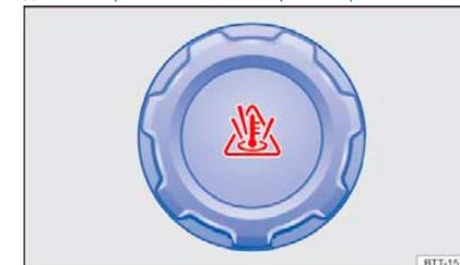
Рисунок 132 В моторном отсеке: Крышка бачка охлаждающей жидкости двигателя (схематическое изображение)
