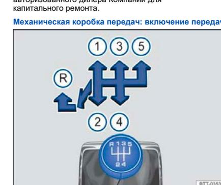
Рисунок 83 Схематическая диаграмма положения передач 5-ступенчатой механической коробки передач
