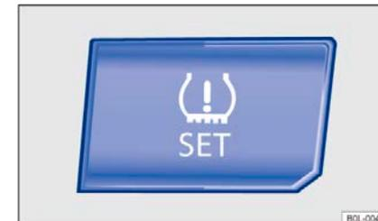
Рисунок 136 Центральная консоль: кнопка контроля давления в шинах
