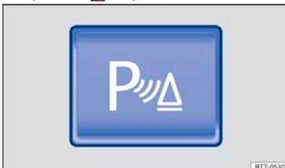
Рисунок 97 Центральная консоль: кнопка включения/выключения системы предупреждения о превышении дистанции (схематическое изображение)
