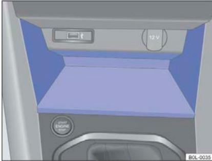
Рис. 100 Передняя часть центральной консоли: вещевой ящик
