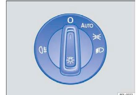
Рисунок 63 Рядом с рулевым колесом: выключатель освещения (данный тип приведен только в качестве примера)
