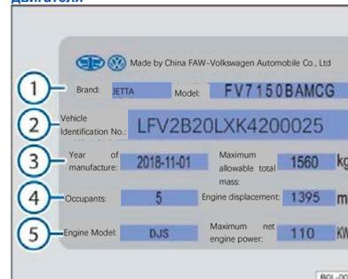
Рисунок 152 Табличка с данными автомобиля (схематическое изображение)
