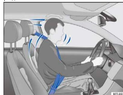
Рисунок 23 Водитель, правильно пристегивающийся ремнями безопасности во время экстренного торможения, надежно защищен
