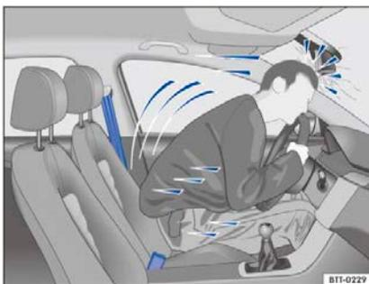
Рисунок 21. Водитель, не пристегнутый ремнем безопасности в момент столкновения, резко отбрасывается вперед.
